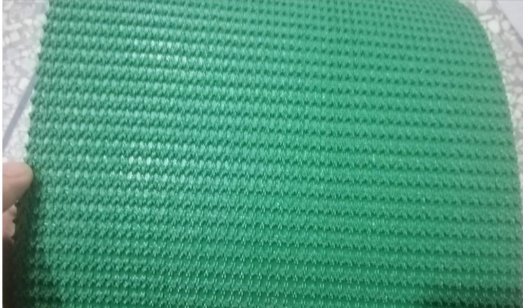
免凿毛止浆带是一种新型的复合材料，可以根据现场需要制作成各种尺寸，使施工更加方便而且可以重复使用。在一般情况下加固桥梁或施工时为了使新老水泥混凝土之间能够融合的更加完整需要人工采用凿毛机、铣刨机等大型设备在平整的毛面上制造麻面效果，即费时费力不说麻面效果分布的也不均匀，容易破坏板梁结构，较大增加了施工成本而免凿毛止浆带解决了这些问题，只需要贴在毛面上，它就会自动形成一个整齐的麻面，即方便快捷也可以重复使用，较大减少了人工成本。在使用时需要注意，当混凝土初步凝结后要及时的拆除以防过度凝固而难以拆除，当然也不要过早的拆除而造成表层混凝土脱落。
